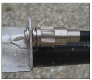
Ci-dessous à droite l'attaque entre le 75 Ohms et le fil avec un simple domino. A droite l'encoche de maintient du fil sur les croix.
